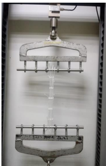
Foto 02 - Resistência à tração na direção longitudinal
